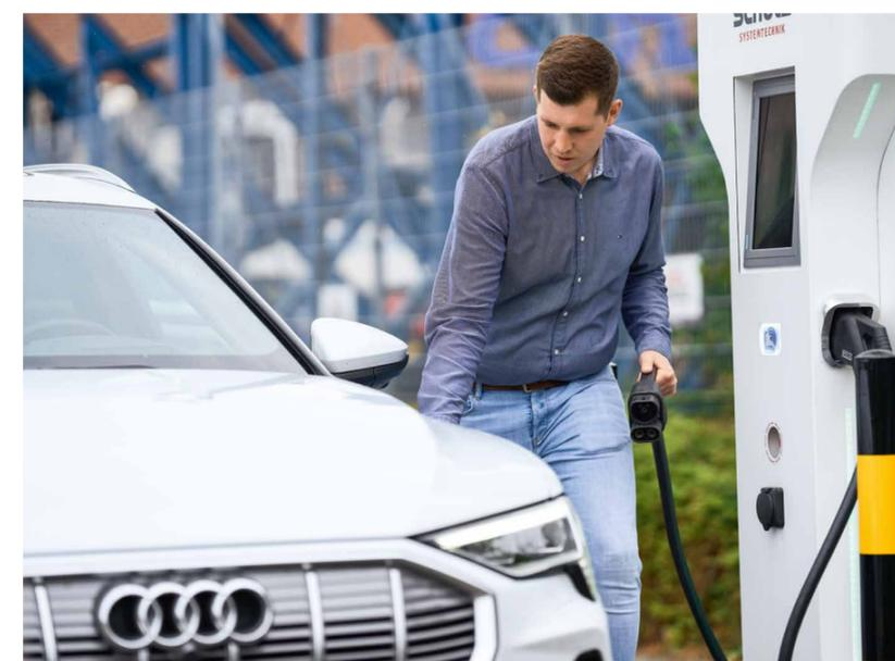
**Einfaches Handling macht's möglich:** Das Aufladen funktioniert wie das Auftanken an einer herkömmlichen Tankstelle. Die Batteriespeicher-Lösung von Commeo befindet sich direkt neben der E-Ladesäule, sicher untergebracht in einem Outdoor-Gehäuse von Rittal (rechts Mitte).
